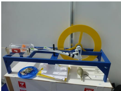
圖4：透明蒸汽機與已經商品化的史特林引擎教具
