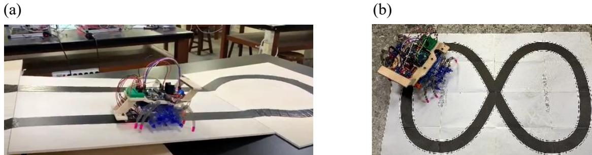
圖三 循跡行走蜘蛛獸在(a)爬坡(b)挑戰”8”字軌跡的照片。
