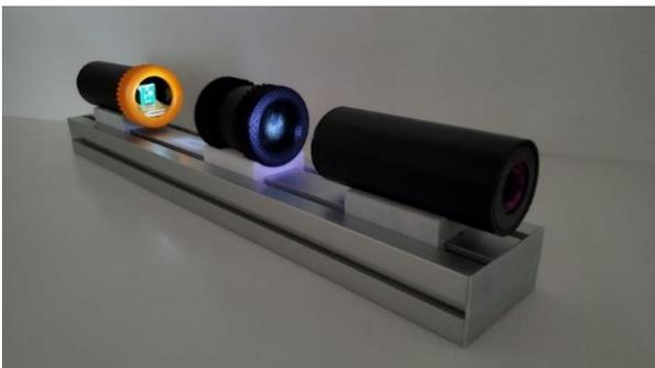
圖二：本實驗教具實物照片，從左到右是光敏電阻，兩片偏振片組合及光源。
