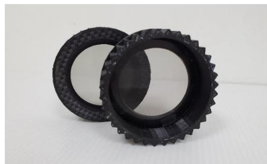
圖三：使用 3D 列印機製作兩個具有鋸齒刻度的圓盤，各固定一片偏振片，注意圓盤的周邊具有 36 個鋸齒，每轉動一鋸齒發出一響聲，表示轉動 10 度。注意照片中間重疊區顯示全暗是因為兩偏振片的光軸夾 90 度。
